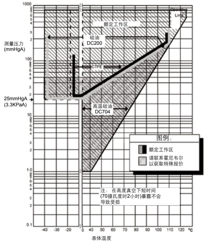
图3 STA822/STA82L的测量压力和膜盒温度图
