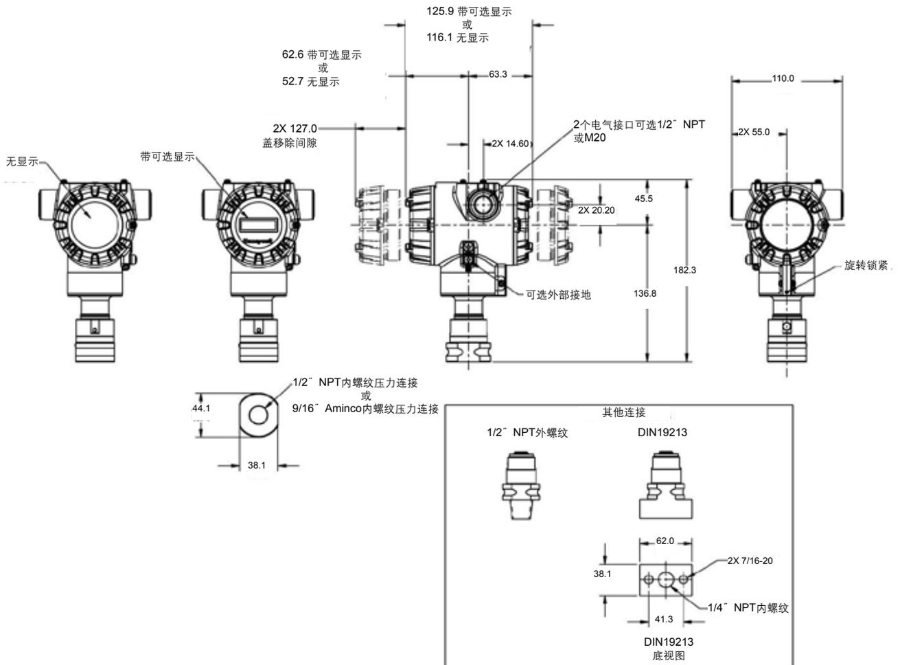
图5 STA82L、STA84L和STA87L典型安装尺寸图
