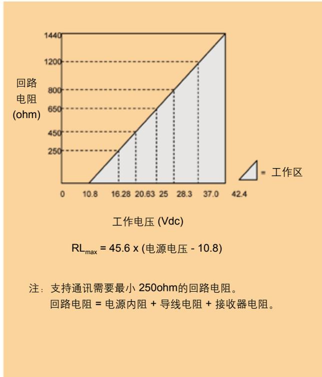
图2 电源电压和回路电阻图及计算
