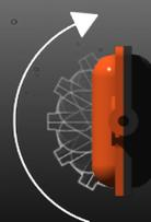
Les indicateurs REVEAL™ intègrent une *butée pré réglée* qui limite la rotation de chaque palette à un demi-tour. Ceci élimine le phénomène de rotation excessive souvent observé avec d'autres types d'indicateurs.
