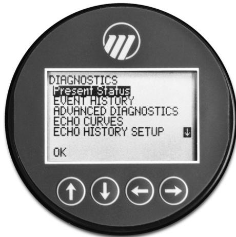
Wenn der Messumformer normal arbeitet und der markierte Cursor auf Aktueller Status steht, zeigt die untere LCD-Zeile OK an, weil kein Diagnoseindikator aktiv ist.
