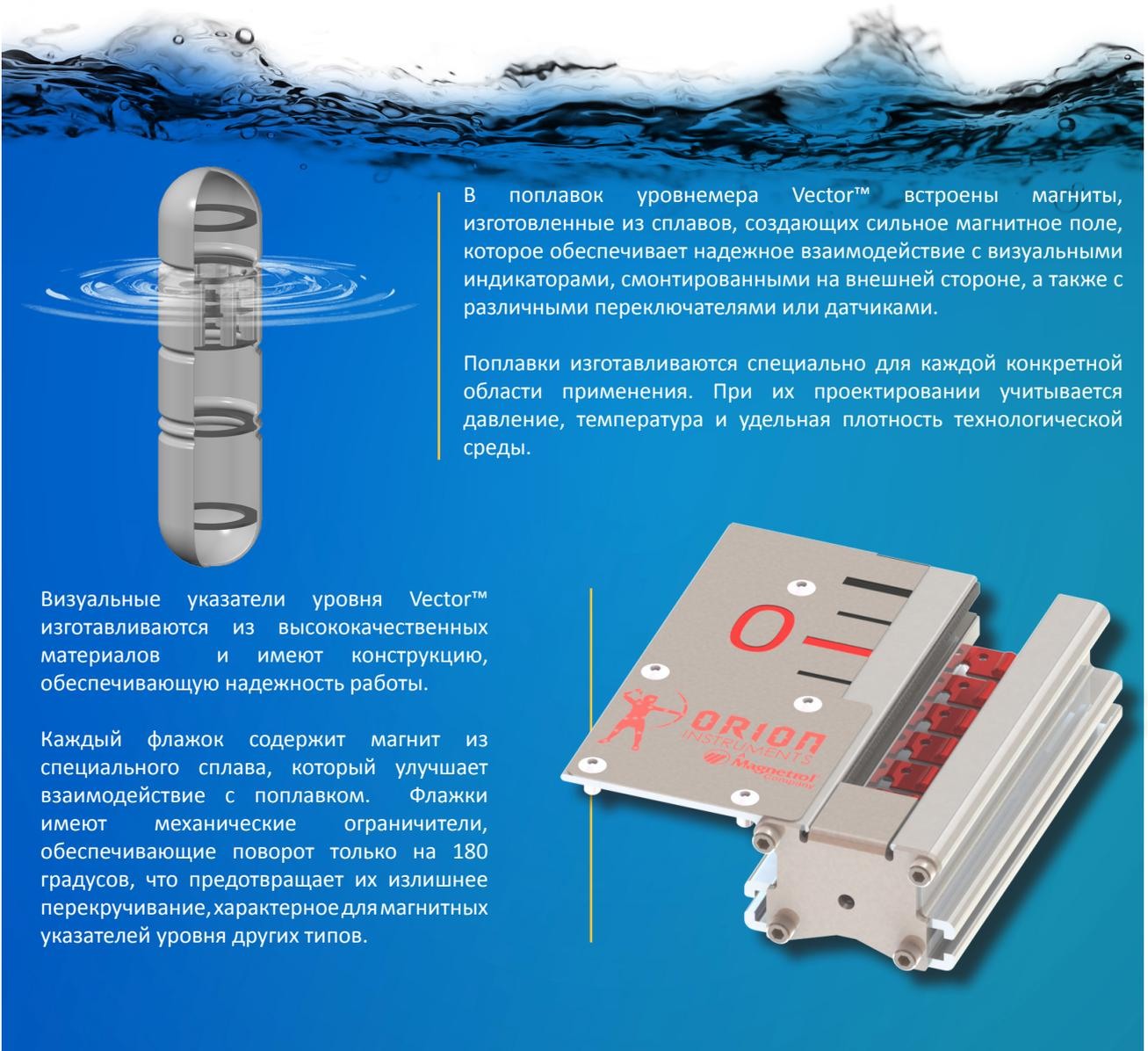
В поплавок уровнемера Vector™ встроены магниты, изготовленные из сплавов, создающих сильное магнитное поле, которое обеспечивает надежное взаимодействие с визуальными индикаторами, смонтированными на внешней стороне, а также с различными переключателями или датчиками.
