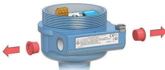
4. Puxe os cabos através do prensa-cabos/conduíte.
