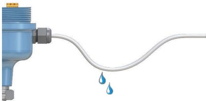
8. Conecte e sele a conexão de conduíte não utilizada para evitar acúmulo de umidade e poeira no interior da caixa.
