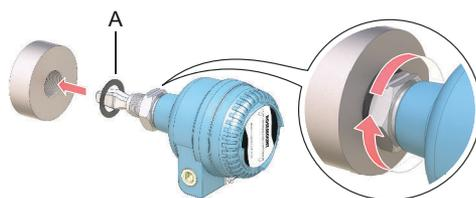
A. Junta para conexão rosca de BSPP (G)
