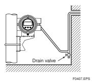
Figure 4.3.4 Conduit Wiring
