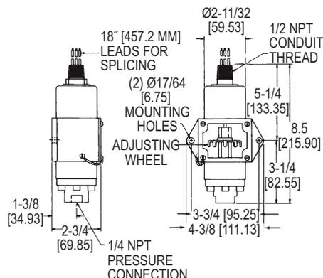
Este presostato opera mediante un diafragma reforzado por resorte, del tipo Bellville.
