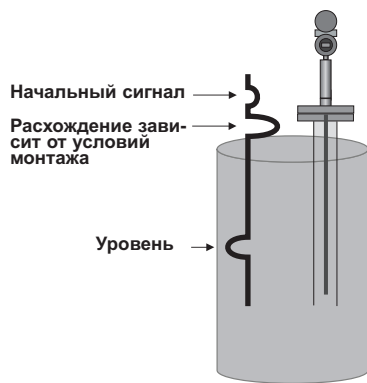
Одностержневой зонд в успокоительном колодце
