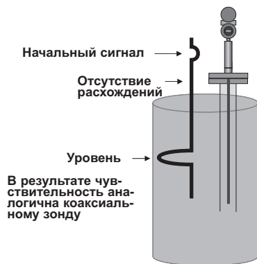
Камерный зонд (форма сигналов такая же, как у коаксиального зонда)
