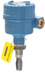
Der Rosemount 2120 Füllstandsgrenzschalter bietet einfach zu installierende, zuverlässige Füllstands-erkennung und -regelung. Dank Sicherheits- und Hygienezertifizierung gemäß IEC61508 (SIL2) durch Dritte und einer Auswahl an Ausgängen ist er für ein breites Anwendungsspektrum geeignet. Er hat keine beweglichen Teile, muss nicht kalibriert werden und ist praktisch unbeeinflusst von Prozessbedingungen. Einstellbare Schaltverzögerung vermeidet Fehlschaltungen in turbulenten Anwendungen.
