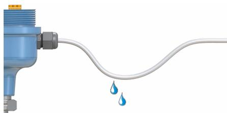
8. Tape e vede a ligação da conduta não utilizada para evitar humidade e acumulação de pó no interior da caixa.
