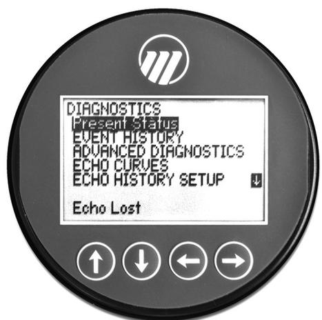
Lorsque le transmetteur fonctionne normalement et que le curseur est positionné sur Etat Actuel, la ligne inférieure de l'écran LCD indique "OK", car aucun indicateur de diagnostic n'est actif.
